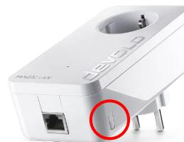
Ambos os adaptadores têm os LEDs ligados permanentemente.
